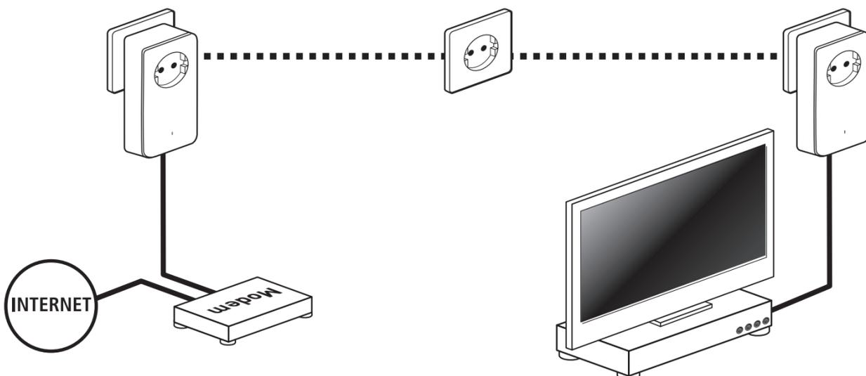
**Powerline-Verschlüsselung:** Bitte drücken Sie die Verschlüsselungsknöpfe, innerhalb von 2 Minuten, jeweils für 1 Sekunde.
