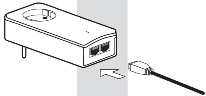
Anschluss des Adapters an den Router / Connect broadband router
