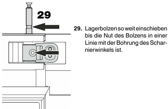
29. Lagerbolzen so weit einschieben bis die Nut des Bolzens in einer Linie mit der Bohrung des Scharnierwinkels ist.
