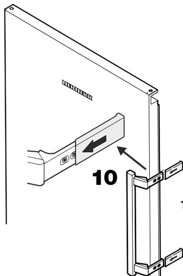
10. Druckplatten aufschieben bis sie einrasten.
