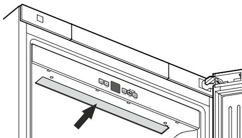
Die Lichtintensität der LED-Beleuchtung entspricht der Laserklasse 1/1M.
