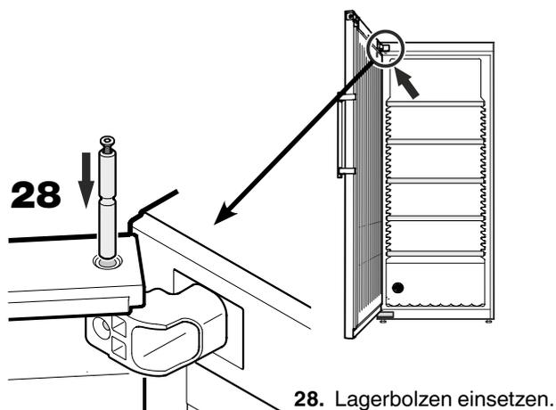
28. Lagerbolzen einsetzen.
