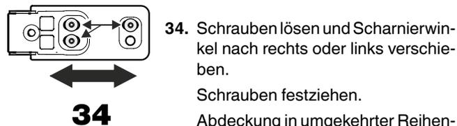
34. Schrauben lösen und Scharnierwinkel nach rechts oder links verschieben.
