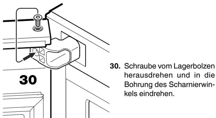
30. Schraube vom Lagerbolzen herausdrehen und in die Bohrung des Scharnierwinkels eindrehen.
