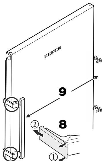
8. Druckplatten vorne austrasten 1 und nach hinten abziehen 2.
