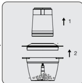
Prvo povucite i uklonite jedinicu motora (4), a zatim poklopac (3).
