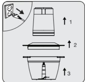
Koble fra apparatet. Fjern motorenheten (4) og lokket (3) og deretter skjærebladet.
