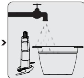
Iskopčajte uređaj iz strujne mreže. Uklonite jedinicu motora (4), poklopac (3), a zatim oštice (6).
