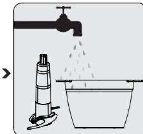
Koppla ur apparaten. Ta bort motorenheten (4), locket (3) och därefter bladen (6).
