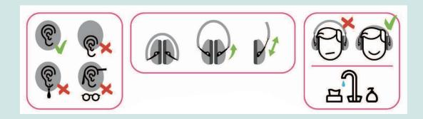
MINIMUM SOUND ATTENUATION SNR=27dB H=32dB M=24dB L=16dB
