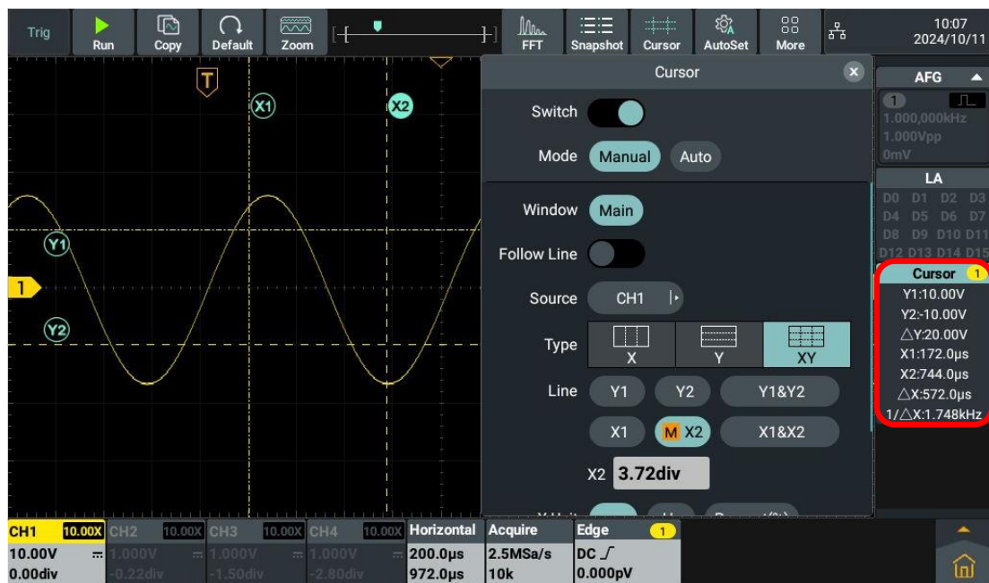
Abbildung 5-9: Zeit- und Spannungs-Cursor-Messung
