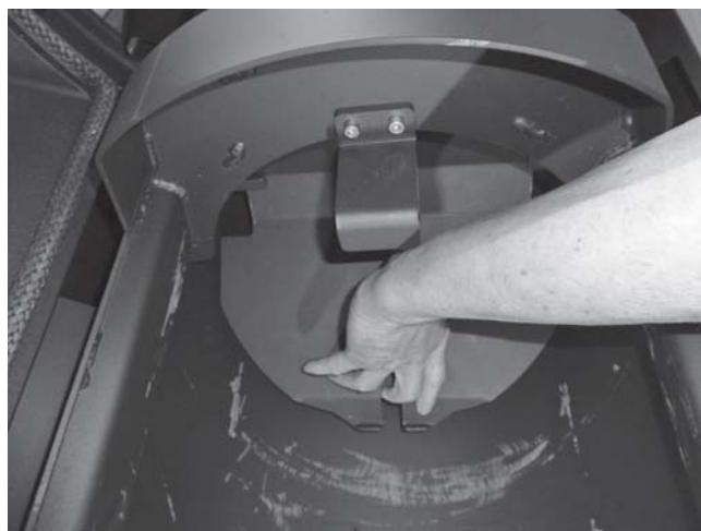
Abschließend muss der Gussboden entfernt werden:
