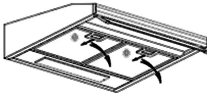
Nach Entfernen der Kunststoffplatte/Deckel ( Ausdrücken des perforierten Deckels) kann der Adapter (optional) aufgedrückt werden, auf den der Abluftschlauch gesteckt wird.
