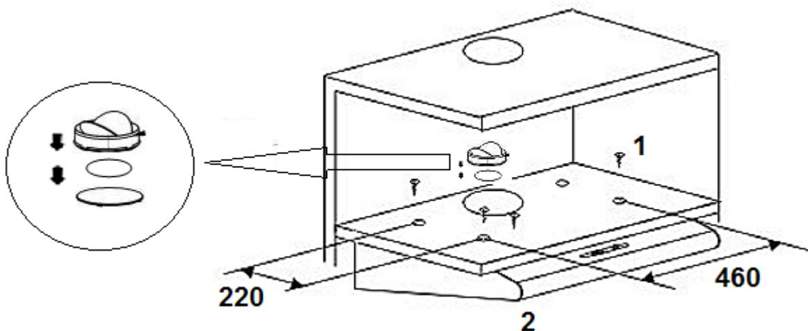
1. Bohren Sie vier Löcher (Ø 4 mm) in die Unterseite des Schanks.
