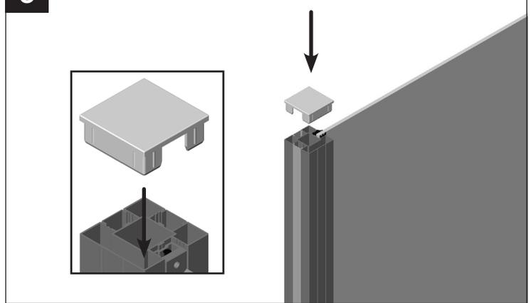
**ALTERNATIV:** Sichtschutz- oder Holz-Elemente an optionalen Winkelschienen zwischen Pfosten montieren
