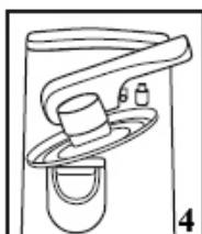
Wanneer het blik geheel is geopend, stopt het snijden vanzelf. Het blik blijft op z'n plaats, totdat de hendel opgetild wordt.
