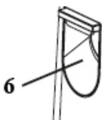
Para abrir una botella, tómela y mantenga la tapa bajo el "gancho" de metal del abrebotellas que se encuentra en la parte delantera del aparato, bajo la palanca del abrelatas.
