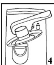
Cuando la lata está totalmente abierta, el proceso de corte se detiene automáticamente. La lata permanece en su posición hasta que la palanca se levante.
