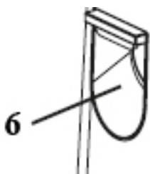
Om een fles te openen plaatst u de dop onder de metalen "haak" in de flesopener, die zich aan de voorkant van het apparaat onder de blikopenerhendel bevindt.
