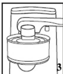
Drücken Sie den Öffnerhebel fest nach unten und halten Sie diesen fest, bis der Dosendeckel automatisch durchbohrt ist und das Schneiden beginnt wie in Abbildung 3.
