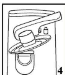
Wenn die Dose vollständig geöffnet ist, stoppt der Schneidvorgang automatisch. Die Dose verbleibt in ihrer Position, bis der Hebel angehoben wird. Zum Lösen, die Dose mit einer Hand festhalten und den Hebel mit der anderen Hand anheben. Der magnetische Deckelhalter hält den Deckel fest wie in Abbildung 4.
