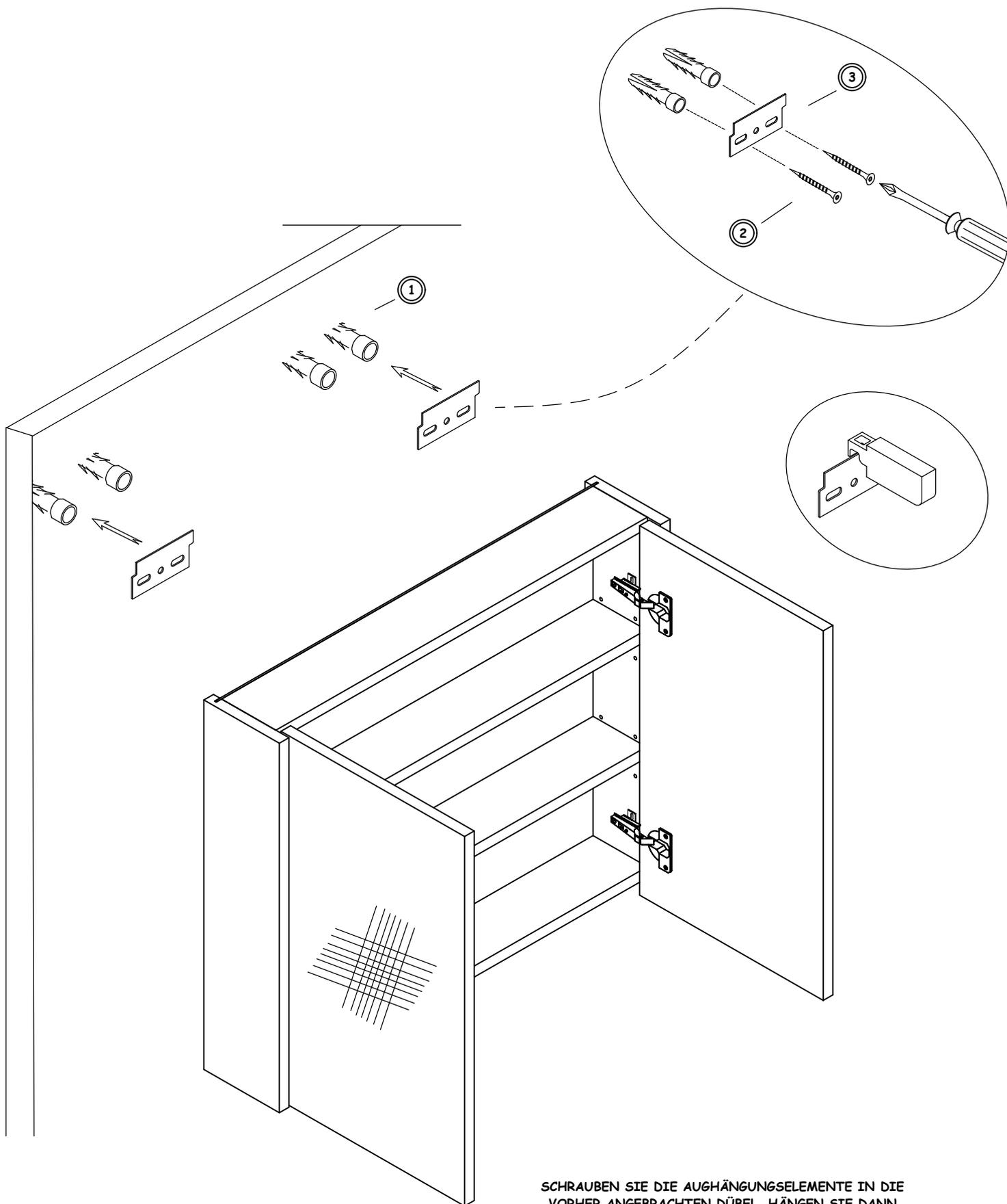
SCHRAUBEN SIE DIE AUFHÄNGUNGSELEMENTE IN DIE VORHER ANGEBRACHTEN DÜBEL. HÄNGEN SIE DANN DIE IM SCHRANK BEFINDLICHEN HAKEN AN DIE AUFHÄNGUNGSELEMENTE AN DER WAND.
