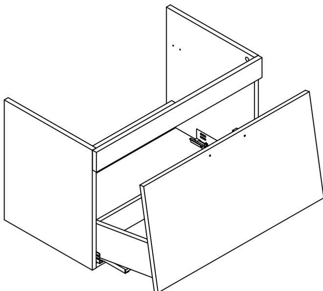
SCHIEBEN SIE DIE SCHUBLADE, ENTSPRECHEND DER ANWEISUNG AN DEN SCHIENEN EIN. ANHAND DES CLICK-GERÄUSCHS HÖREN SIE, DASS DIE SCHUBLADE NUN IN DER RICHTIGEN POSITION SITZT.
