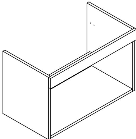
SCHIEBE MIT HILFE DER EURO SCHRAUBEN AN DEN INNENSEITEN DES SCHRANKKORPUSSES AN DEN VORGESEHENEN SPUREN BEFESTIGEN. (SCHIENE WIRD VORNE AM 2. LOCH UND VON HINTEN AM 3. LOCH ANGESCHRAUBT)
