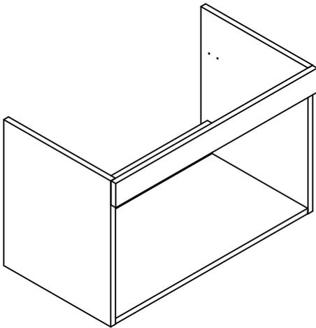
SCHIENE MIT HILFE DER EURO SCHRAUBEN AN DEN INNENSEITEN DES SCHRANKKORPUSSES AN DEN VORGEGEHENEN SPUREN BEFESTIGEN. (SCHIENE WIRD VORNE AM 2. LOCH UND VON HINTEN AM 3. LOCH ANGESCHRAUBT)
