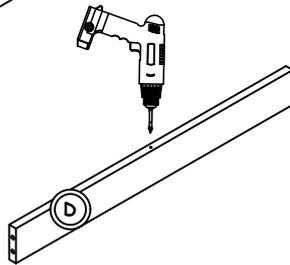
BOHREN SIE EIN LOCH AM UNTEREN BEREICH DES HINTEREN ELEMENTS UNTER VERWENDUNG EINER BOHRMASCHINE UND EINEM 3MM BOHRER.
