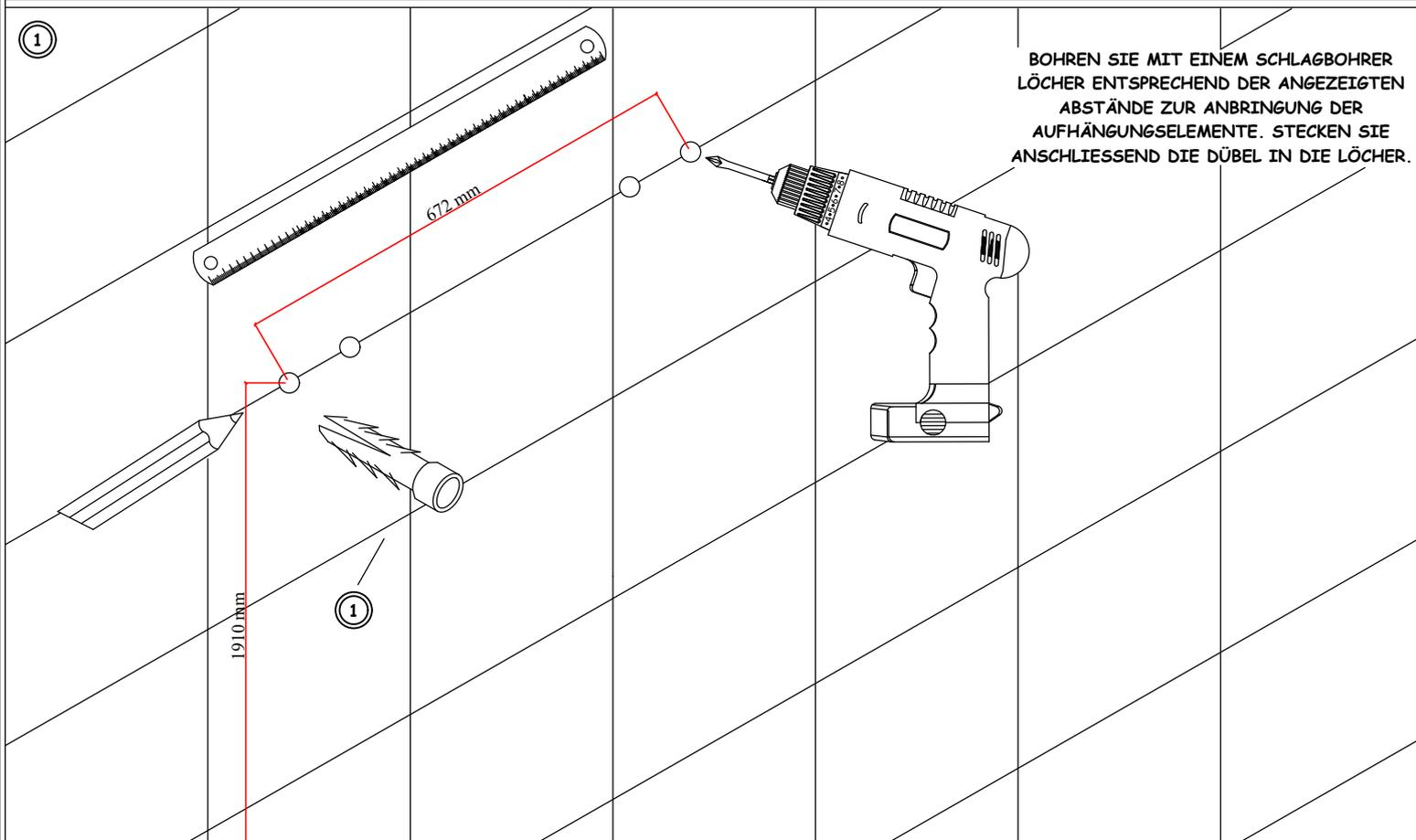
BOHREN SIE MIT EINEM SCHLAGBOHRER LÖCHER ENTSPRECHEND DER ANGEZEIGTEN ABSTÄNDE ZUR ANBRINGUNG DER AUFHÄNGUNGSELEMENTE. STECKEN SIE ANSCHLIESSEND DIE DÜBEL IN DIE LÖCHER.
