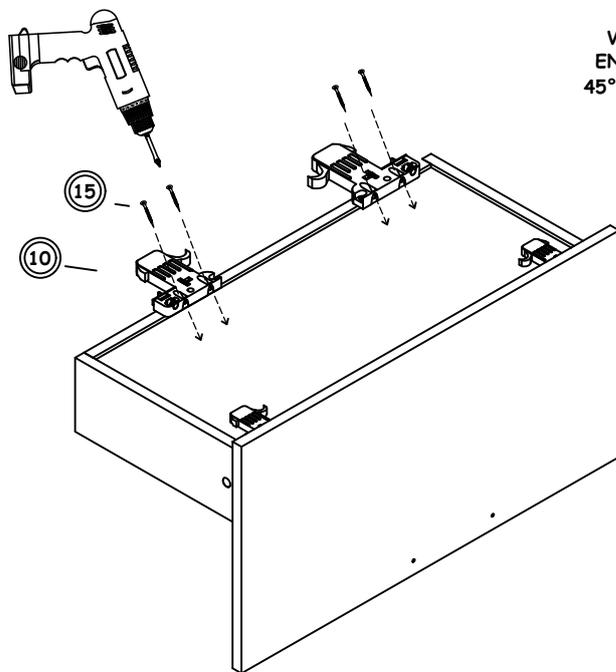
WÄHREND DER VERSCHRAUBUNG DER VERRIEGELUNGSELEMENTE, MÜSSEN DIESE ENTSPRECHEND DER DARSTELLUNG IN EINEM 45° WINKEL SCHRÄG EINGESCHRAUBT WERDEN.
