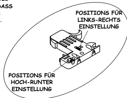
NACHDEM DIE SCHUBLADEN ANGEBRACHT SIND, KÖNNEN ÜBER DIE VERRIEGELUNGSELEMENTE LEICHTE EINSTELLUNGEN LINKS-RECHTS UND HOCH-RUNTER VORGENOMMEN WERDEN.
