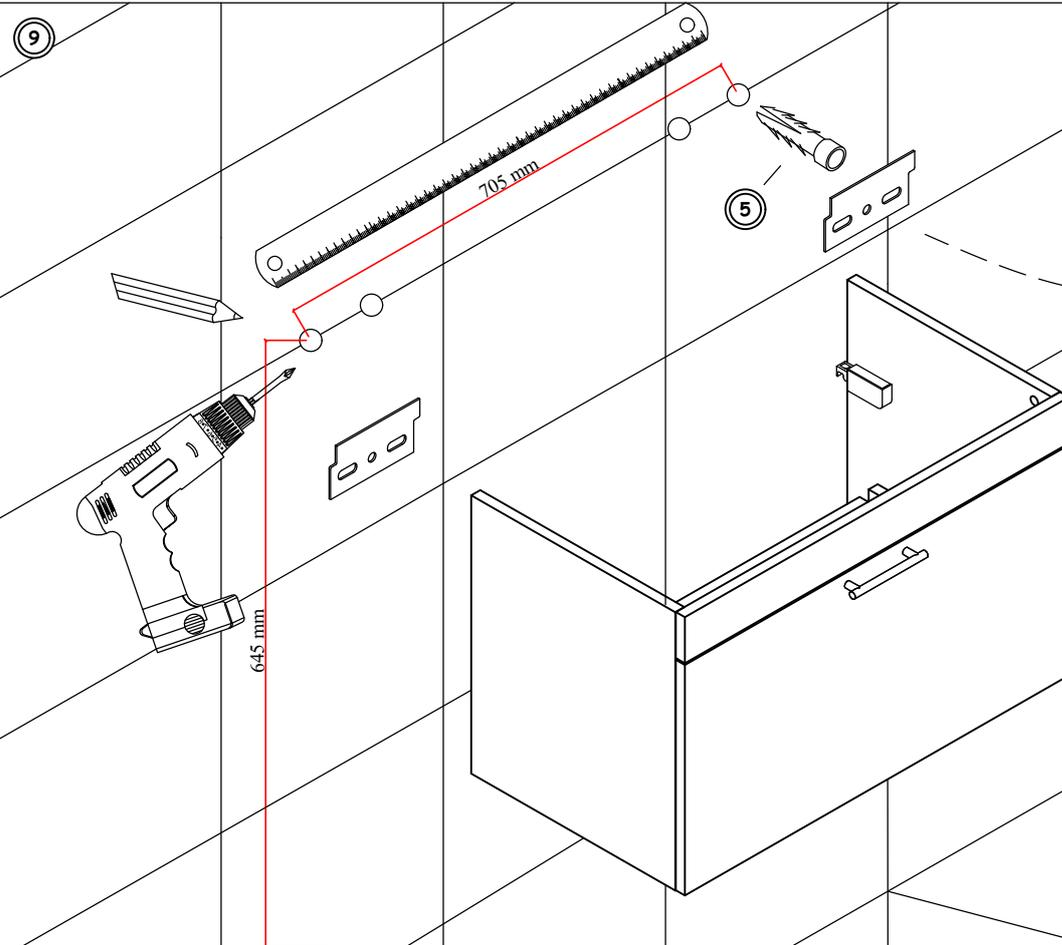
BOHREN SIE MIT EINEM SCHLAGBOHRER LÖCHER ENTSPRECHEND DER ANGEZEIGTEN ABSTÄNDE ZUR ANBRINGUNG DER AUFHÄNGUNGSELEMENTE. STECKEN SIE ANSCHLIEßEND DIE DÜBEL IN DIE LÖCHER. VERSCHRAUBEN SIE DIE AUFHÄNGUNGSELEMENTE IN DIE ANGEBRACHTEN DÜBEL.
