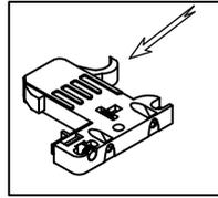
DURCH DAS GLEICHZEITIGE DRÜCKEN AUF DIE SCHULTERN DER VERRIEGELUNGSELEMENTE, KANN DIE SCHUBLADE AUS DEM SCHRANK ENTNOMMEN WERDEN.
