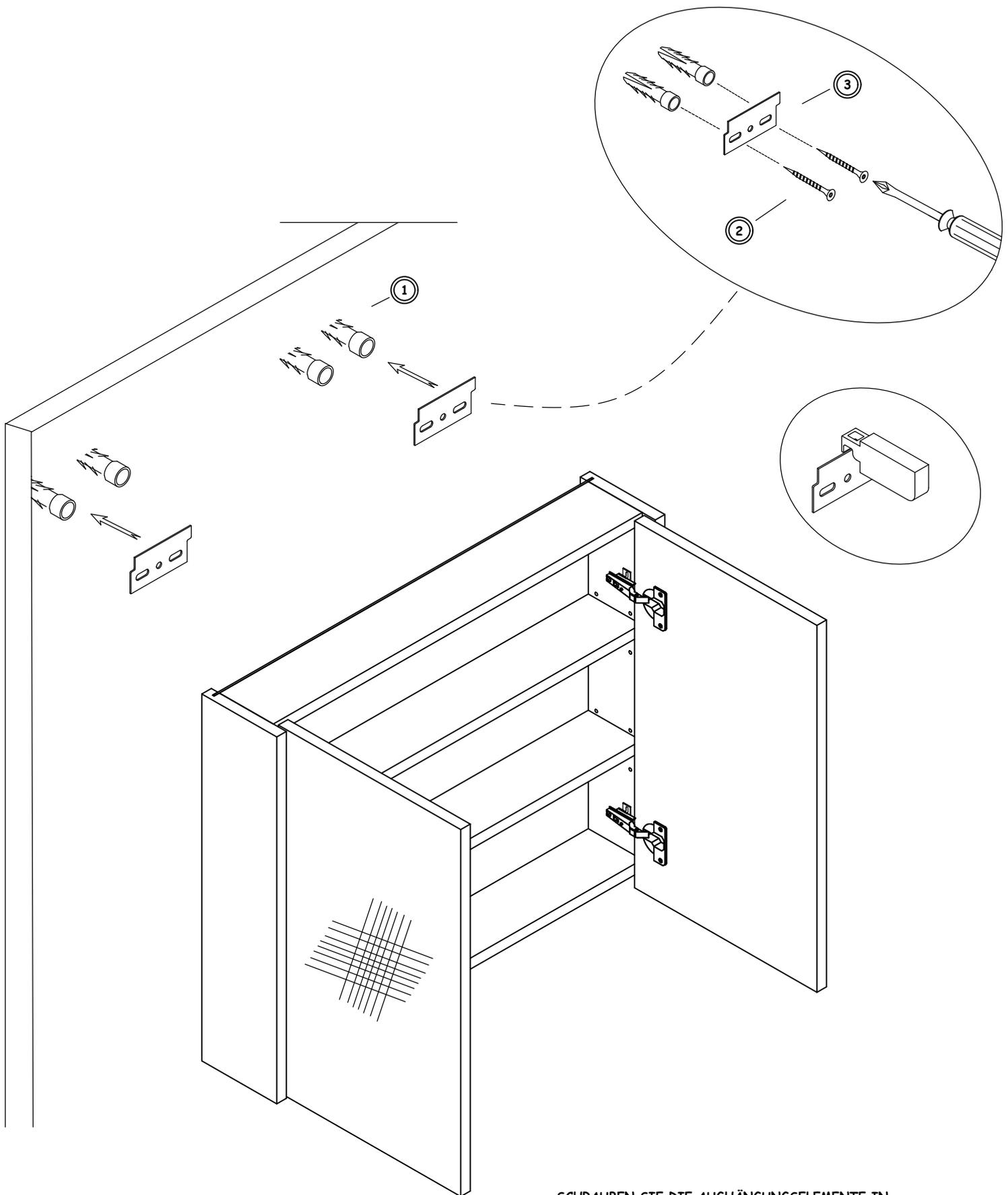
SCHRAUBEN SIE DIE AUFHÄNGUNGSELEMENTE IN DIE VORHER ANGEBRACHTEN DÜBEL. HÄNGEN SIE DANN DIE IM SCHRANK BEFINDLICHEN HAKEN AN DIE AUFHÄNGUNGSELEMENTE AN DER WAND.
