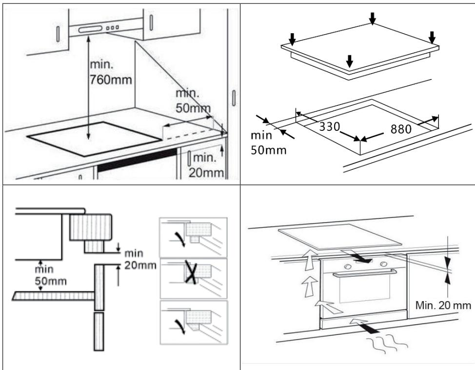
**Nota:** Respete las distancias mínimas entre la parte inferior del aparato y la pared de separación (mín. 50 mm).
