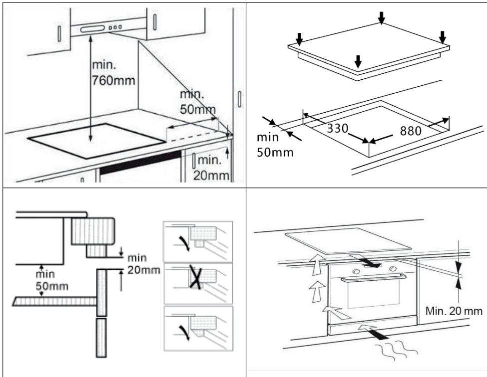
**Nota:** rispettare la distanza minima della parte inferiore del dispositivo e della parete divisoria (min. 50 mm).
