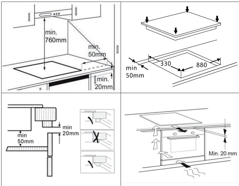
**Remarque :** Respectez les distances minimales entre le dessous de l'appareil et la cloison (min. 50 mm).
