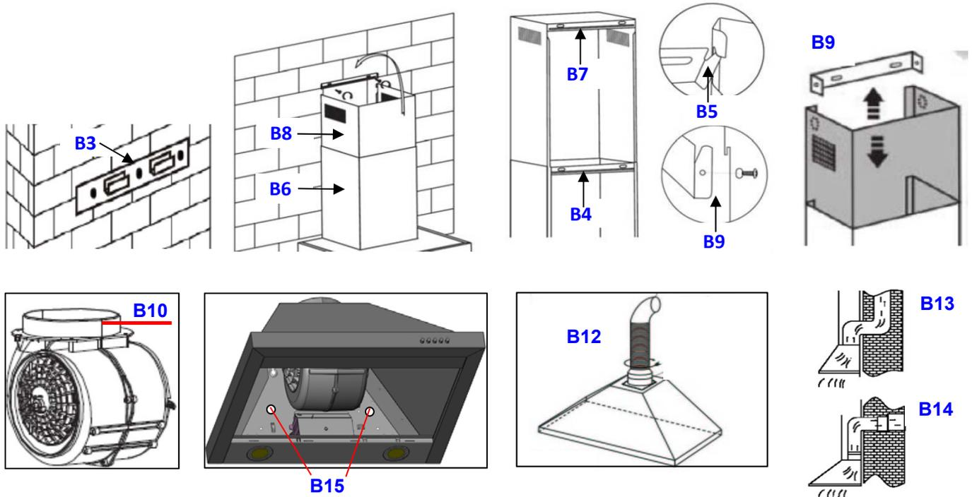
15. Die Haube an Halterung **B3** wieder aufhängen und durch die 2 Löcher in der Rückwand **B15** festschrauben, damit die Haube nicht versehentlich aushängen kann.
