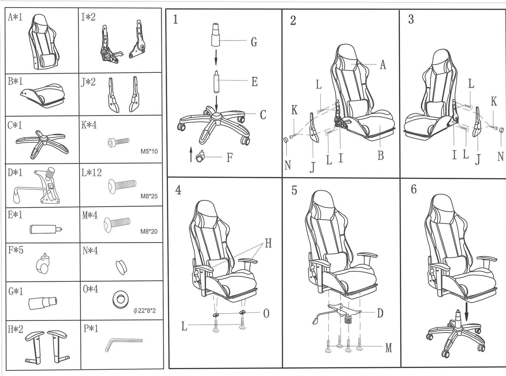
**Aufbau Tipp:** Drehen Sie zunächst alle Schrauben locker ein und ziehen Sie sie nach dem fertigen Aufbau fest.
