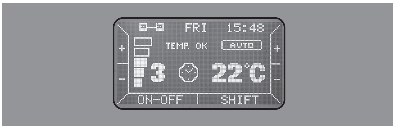
Abb. 11: Display-Anzeige bei Automatikbetrieb
