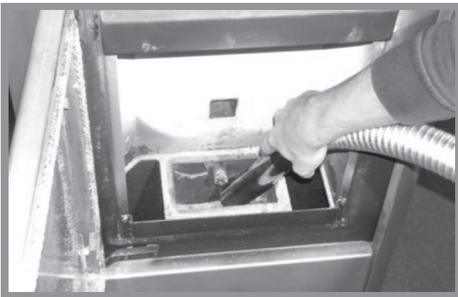
Abb. 12f: Reinigung Brennraumbehälter
