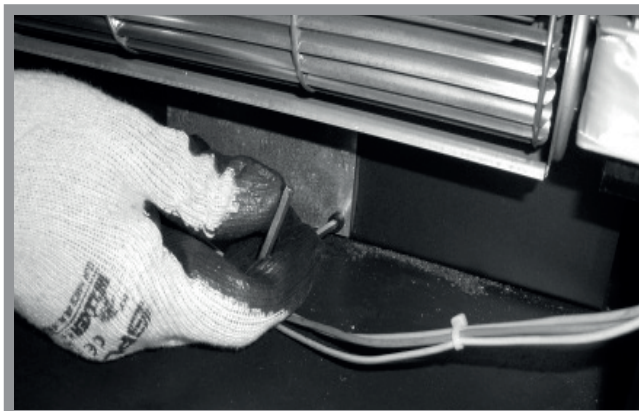
Abb. 13b: Aufschrauben der inneren Abdeckplatte
