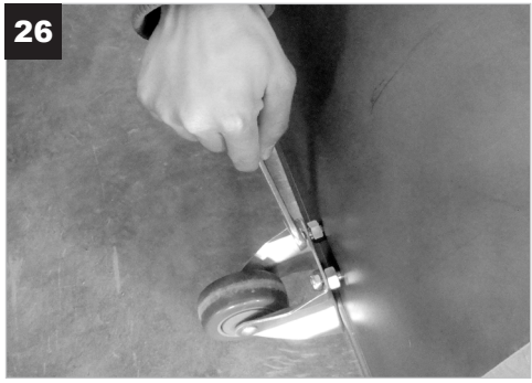
Befestigen Sie unten auf der Rückseite des Schneeschilds die zwei Stützräder mit je 4 Schrauben und Muttern.
