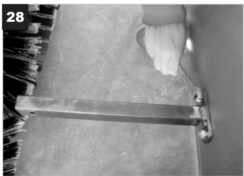
Schrauben Sie mittig auf der Rückseite des Schneeschilds die mittlere Montagestrebe an
