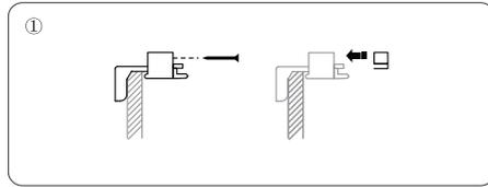
① Befestigen Sie die beiden Aufhängelaschen am Fensterrahmen und sichern Sie sie mit Schrauben. Setzen Sie anschließend die Abdeckkappen auf die Halterungen.
