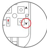
**Schritt 2:** (Auf der Rückseite der Fernbedienung) Halten Sie die Taste "▼" gedrückt, bis der Motor einmal zuckt – damit wird die untere Endposition gespeichert.
