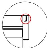
**Schritt 2:** Halten Sie die "M"-Taste am Motor (oben rechts am Rollo) 3 Sekunden lang gedrückt. Der Motor zuckt einmal – das zeigt an, dass der Kopplungsmodus aktiviert wurde.
