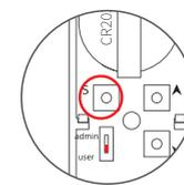
**Schritt 3:** Halten Sie die "S"-Taste auf der Fernbedienung 2 Sekunden lang gedrückt. Der Motor zuckt erneut, um die erfolgreiche Kopplung zu bestätigen. Jetzt können Sie mit Funktion 1 oder Funktion 2 fortfahren, um die obere und untere Grenze einzustellen.
