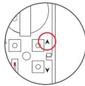
**Schritt 2:** (Auf der Rückseite der Fernbedienung) Halten Sie die Taste "▲" gedrückt, bis der Motor einmal zuckt – damit wird die obere Endposition gespeichert.
