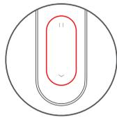
**Schritt 1:** (Auf der Vorderseite der Fernbedienung) Drücken Sie die Abwärtstaste einmal, um das Rollo langsam abzusenken, oder zweimal, um es schnell abzusenken. Sobald die gewünschte untere Position erreicht ist, drücken Sie die Pausentaste, um das Rollo zu stoppen.
