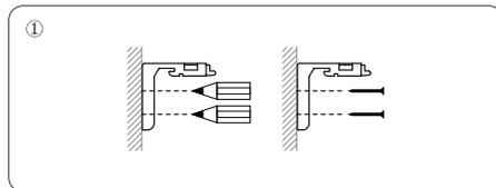
① Markieren Sie die Positionen der beiden [B] Halterung mit einem Bleistift. Verwenden Sie diese Markierungen als Platzierungsreferenz. (Wir empfehlen eine Markierung bei 1/3 und 2/3 der gesamten Länge des Rollos.) Befestigen Sie anschließend die Halterungen mit [E] Schrauben und Dübeln.
