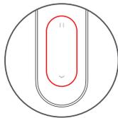
Halten Sie beide Tasten gedrückt, bis der Motor zuckt – dies zeigt an, dass sich die Geschwindigkeit um eine Stufe erhöht oder verringert hat.
