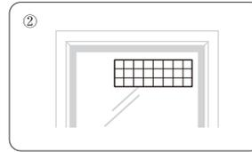
② Befestigen Sie das [F] Solarpanel am Glas (siehe Solarpanel-Handbuch für detaillierte Anweisungen).
