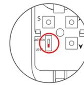
**Schritt 3:** Schalten Sie die Fernbedienung zurück in den "Benutzer"-Modus für den normalen Gebrauch.
