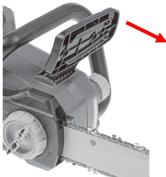
Zum Lösen der Kettenbremse ziehen sie den Handschutz in Richtung des Bügelgriffs (siehe folgende Abbildung).
