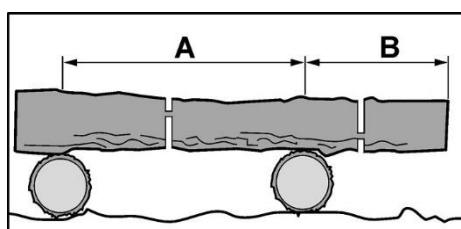
Nota: ¡Noerrar troncos en tensión! Las astillas de madera o la inclinación de la sierra pueden causar lesiones graves.
