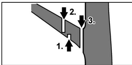
Achtung: Äste, die aufliegen oder unter Spannung stehen, können die Sägekette im Holz verkeilen!
