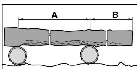
Importante: Não serre toras que estejam sob tensão! Lascas de madeira ou uma barra de serra inclinada podem causar ferimentos graves!
