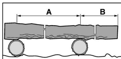
Important : Ne pas scier des troncs sous tension ! L'éclatement du bois ou l'inclinaison du guide-chaîne peuvent causer des blessures graves !
