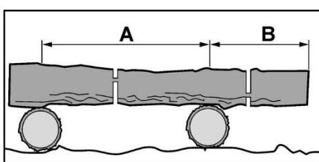
Wichtig: Sägen Sie keine unter Spannung stehenden Stämme! Splitterndes Holz oder eine verkantete Sägeschiene können zu schwersten Verletzungen führen!
