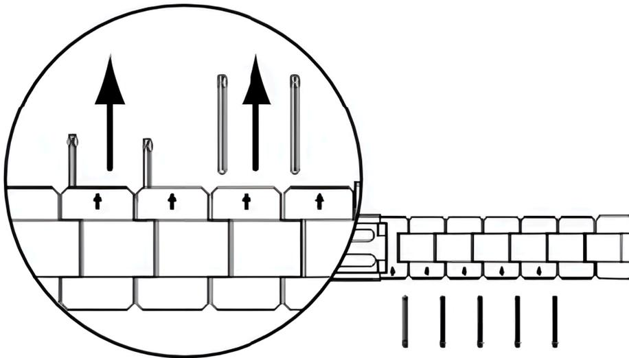
Legen Sie das Band so, dass der Stift in Pfeilrichtung mit dem Bandwerkzeug **(1)** herausgedrückt werden kann **(2)**.
