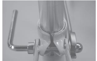
**Die Sattelstütze muss mindestens bis zur Markierung im Sitzrohr stecken, das heißt die Markierung darf nicht sichtbar sein - Bruchgefahr!**
