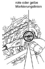
Die roten oder die gelben Markierungslinien der Schalteinheit befinden sich an zwei Stellen. Verwenden Sie die besser sichtbaren Linien.
