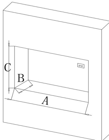
Das grundsätzliche Vorgehen bei der Montage ist identisch wie bei der Variante des Teileinbaus. Beachten Sie lediglich die abweichende Position, an der die Stützwinkel am Gerät angebracht werden müssen. Orientieren Sie sich an den folgenden Skizzen:
