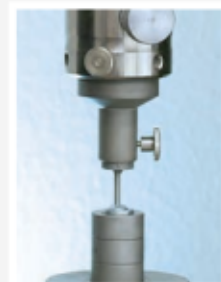
Test Restnietdomverriegelung Mandrel retaining test Essai de résistance au désassemblage de la tige
