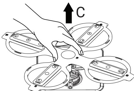
Darstellung 7.6: *Entfernen des unteren Sprüharms*
