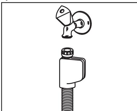
Darstellung 4.4: Wasserzulaufschlauchanschluss
