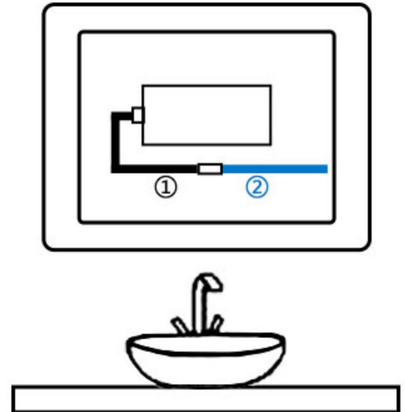
☀️ (B) Schließen Sie den Netzstecker an das Spiegelkabel und dann an die Steckdose an (Netzstecker nicht beinhaltet).
