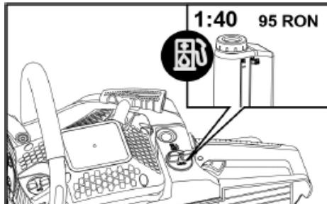
Paliwo stosowane w chłodzonym powietrzem 2-suowym silniku benzynowym to mieszanka benzyny 2-suowej i oleju z dodatkiem przeciwtłuczeniacza do silników 2-suowych.
