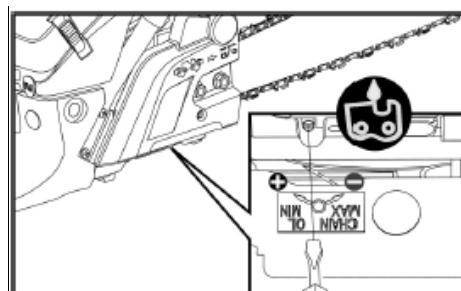
De stelschroef voor de oliedosering bevindt zich aan de onderkant van de kettingzaag. Een label dat hierop is bevestigd, beschrijft hoe de oliestroom voor het smeren van de zaagketting kan worden verhoogd of verlaagd.
