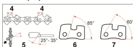
4 Długość pilokształtna      minimum 4 mm
