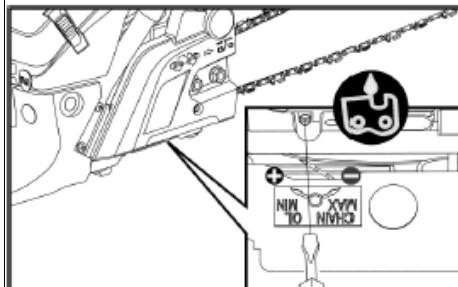
Die Einstellschraube für die Öldosierung ist am Unterboden der Kettensäge angeordnet. Ein dort befestigtes Schild beschreibt das Erhöhen oder Verringern des Ölzuflusses zum Schmieren der Sägekette.
