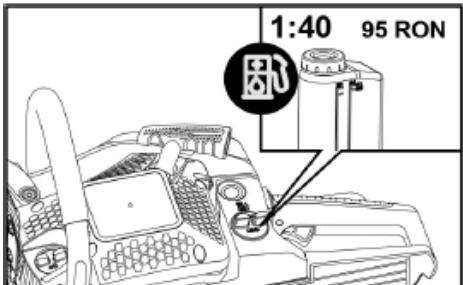
De brandstof die wordt gebruikt voor de luchtkoelde tweetaktbenzinemotor is een mengsel van tweetaktbenzine en olie met een antioxidantadditief voor tweetaktmotoren.
