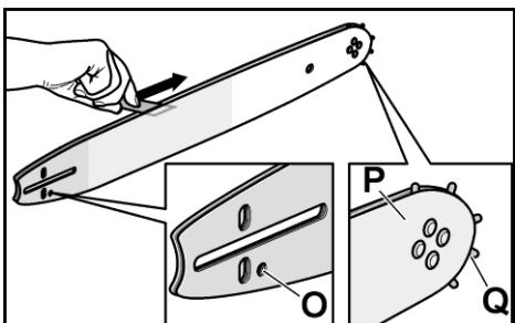
Szyna prowadząca jest zdemontowana:
