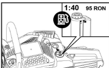
Als Kraftstoff für den luftgekühlten 2-Takt-Benzinmotor wird ein Gemisch aus 2-Takt-Benzin und Öl mit Antioxidationszusatz für 2-Takt-Motoren verwendet.
