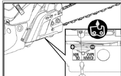
Justeringskruven för oljedosering sitter på undersidan av motorsågen.
