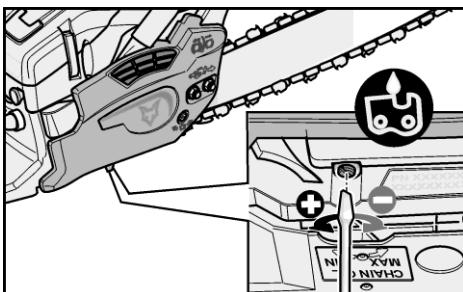
La vis de réglage pour le dosage de l'huile se situe au-dessous de la tronçonneuse.
