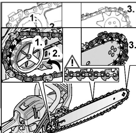
scanalato sul perno dell'unità di azionamento (A) e montare la catena prima sulla ruota motrice (1.), poi sopra la guida inferiore (2.) e poi nella parte anteriore della barra di guida sul cerchio dell'ingranaggio anteriore (Q) nella scanalatura della guida (3.).
