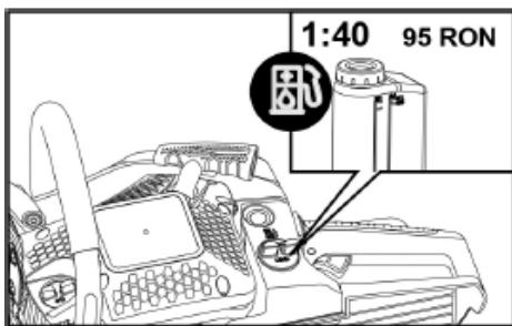
Bränslet som används till den luftkylda 2-takts bensinmotorn är en bländning av 2-takts bensin och olja med en antioxidanttillsats för 2-taktsmotorer.
