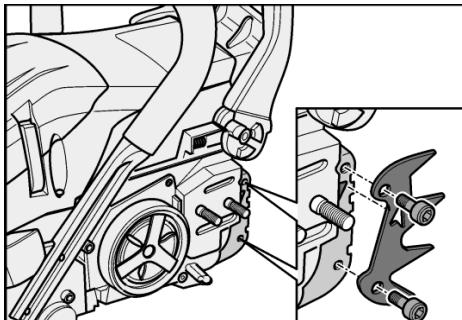
■ Przykręć mocno ogranicznik kłowy (14) do urządzenia za pomocą dwóch śrub imbusowych (H).
