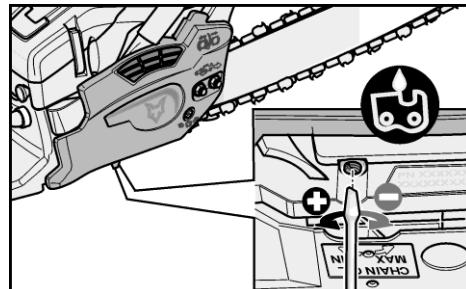
La vite di regolazione per il dosaggio dell'olio si trova sul fondo della motosega.
