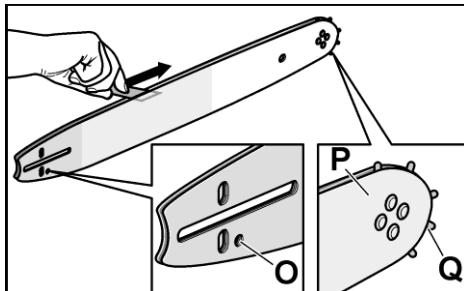
Die Führungsschiene ist demontiert:
