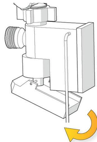
Nach erfolgreicher Installation des Hydro-Stoppers bitte das ausgewählte Haushaltsgerät mit dem Hydro-Stopper-Ausgang, der über ein 3/4"-Außengewinde verfügt, verbinden. Sollte Ihr Gerät über einen anderen Anschlusstyp verfügen, empfehlen wir, einen entsprechenden Adapter zu erwerben, da aufgrund der Vielfalt der Anschlüsse ein solcher Adapter nicht im Montageset enthalten ist.
