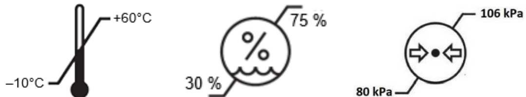
Immagine 4. Simbole und Grenzwerte für die Transport- und Lagertemperatur, Luftfeuchtigkeit und Luftdruck.
