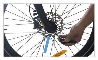
10. Stecken Sie die Schnellspannachse in die Feder und ziehen Sie die Schraube fest (die Schnellspannmutter muss sich am gleichen Ende wie die Bremse befinden).
