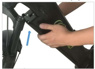
2. Ziehen Sie den Schlüssel ab, nachdem der Akku eingesetzt wurde.
