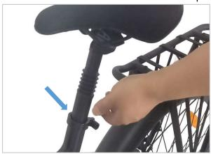
**WARNUNG:** Vergewissern Sie sich nach der Einstellung, dass der Schnellspannhebel der Sattelstütze gut eingerastet ist. Die Sattelstütze darf nicht verrutschen. Es ist strengstens untersagt, die Höhe der Sattelstütze über die Sicherheitslinie hinaus zu erhöhen. Die Markierung darf nicht sichtbar sein!
