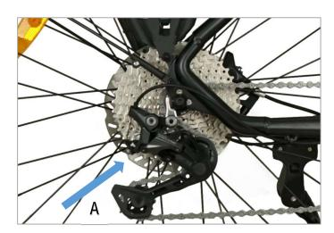
Nicht nach den ersten Fahrten, aber nach einer gewissen Nutzungsdauer, ist die Kette möglicherweise aufgrund der Übertragungsstärke abgenutzt und kann durch eine Spannschraube, die die Kette festhält, richtig eingestellt werden.
