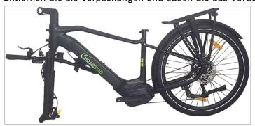
3. Entfernen Sie die Schrauben vom Vorbau.
