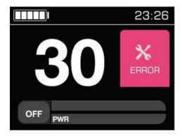
Wenn das Gerät die vom Steuergerät zurückgesendeten Fehlerinformationen empfängt, zeigt es die Fehlercode-Schnittstelle auf der Geräteseite an und fordert den Benutzer mit den relevanten Informationen über den Fehler im elektrischen System auf; der Fehlercode wird numerisch im Geschwindigkeitswertbereich angezeigt.
