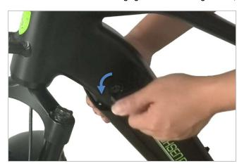
2. A) Stecken Sie dann den Schlüssel wieder ein. B) Drehen Sie ihn gegen den Uhrzeigersinn und entnehmen Sie den Akku.
