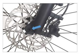
9. Nehmen Sie den Schnellspanner vom Vorderrad ab, drehen Sie die Schraube heraus und setzen Sie den Schnellspanner ein.
