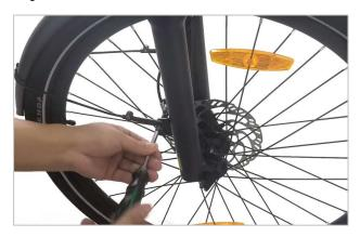
12. Ziehen Sie die Schrauben in den Löchern für das Schutzblech und die Gabel fest.
