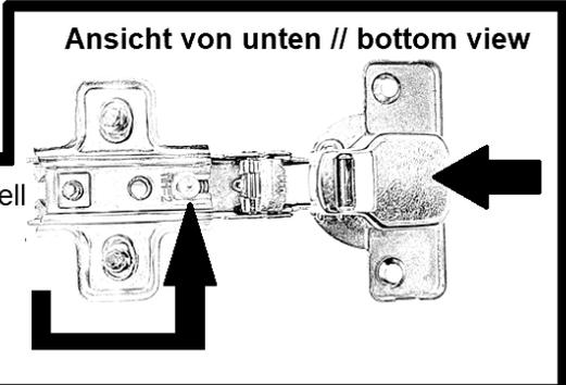
(D) Bitte in Schraubenführung stecken. Eventuell Verstellerschraube leicht herausdrehen.
