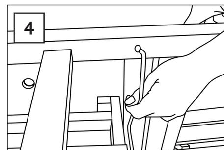
Zum Fixieren der Fußbank werden beide Enden der Führungsschiene vorne und hinten in die dafür vorgesehenen Löcher gesteckt.
