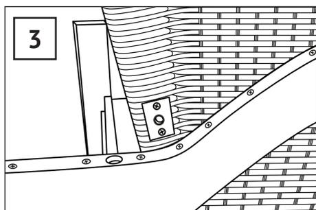
Halten Sie den Oberkorb so zum Unterkorb, dass sich das bereits vormontierte Scharnier des Oberkorbs in der Mitte von zwei Löchern auf der Schiene am Unterkorb befindet.
