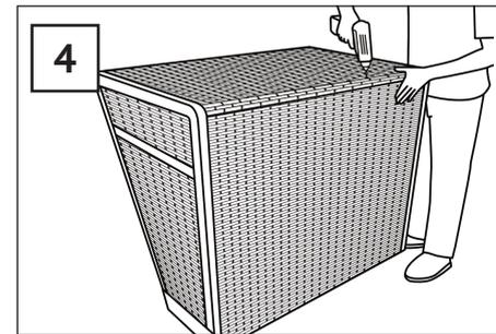
Für zusätzliche Stabilität wird die Dachplatte mit 2 Schrauben (A) an der Rückwand fixiert. Die entsprechenden Stellen sind mit Pfeilen markiert.
