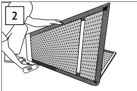
Schrauben Sie die Seitenteile (7) mit je 4 Schrauben (A) an der Rückwand fest. Dabei müssen die Scharniere der Rückwand nach unten zeigen.
