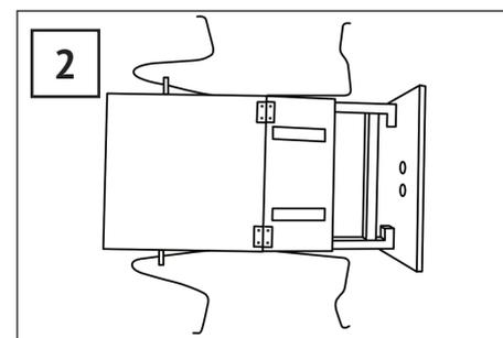
An der Fußbank befinden sich hinten 2 Ringe, durch welche die Führungsschiene (F) gezogen wird.
