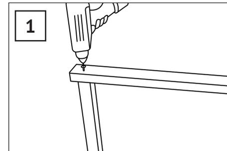
Zur Montage des Stützbügels (11) werden die 3 Einzelstücke mittels 2 Schrauben (C) verbunden.
