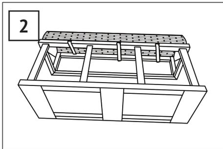
Achten Sie darauf, dass die beiden Verbindungstreben mit der Kante außen montiert werden.
