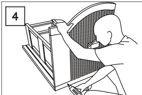
Als nächstes werden die Seitenteile (5) mit je 7 Schrauben (A) an der Basis montiert. Hierfür werden 2 Schrauben an dem Fußbrett und 5 Schrauben an der Basiskonstruktion fixiert.
