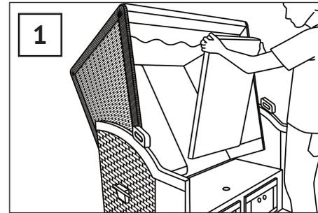
Bringen Sie die Rückenpolster unten in die dafür vorgesehenen Haken und drücken sie anschließend oben an die Rückwand.
