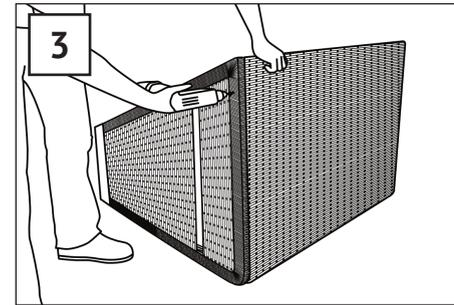
Befestigen Sie die Dachplatte (9) mit jeweils 2 Schrauben (A) an den Seitenteilen.
