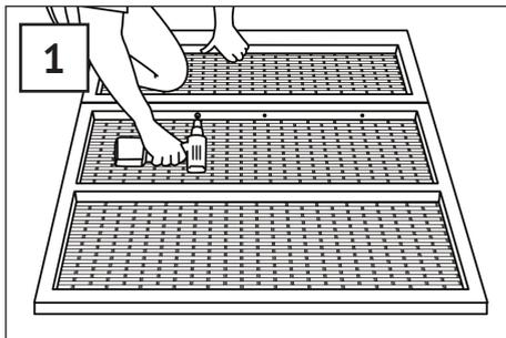
Verbinden Sie die beiden Teile der Rückwand (8) mit 2 Schrauben (A).
