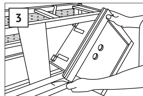
Nach Montage der Führungsschiene kann die Fußbank vorsichtig quer durch die vordere Öffnung der Frontseite eingesetzt werden.
