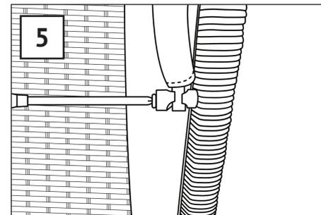
Die Markise (13) wird rechts und links mit jeweils mit einer Schraube (A) inkl. Kunststoffklemmen (D) am Oberkorb befestigt.
