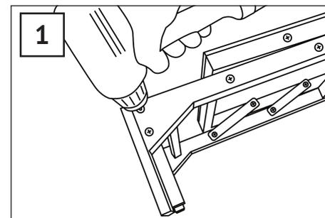
Für die Montage der Fußbank (6) sind 4 Schrauben (B) nötig.
