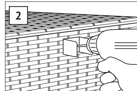
Montieren Sie an der Rückseite des Oberkorbs die U-Profile (H) mithilfe von je 2 Schrauben (C) an den markierten Stellen.
