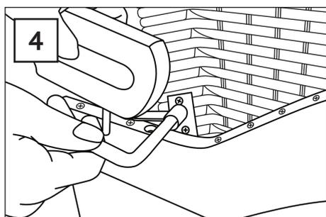
Stecken Sie den Verstellgriff (E) in ein Loch auf der Schiene am Unterkorb und drehen den Bolzen durch den Verstellgriff in den Oberkorb.
