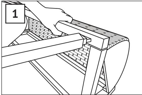
Verbinden Sie die Frontseite (1) mit dem Unterkasten (2). Nutzen Sie hierzu die 4 Verbindungstreben (3) mit Nut und Feder.
