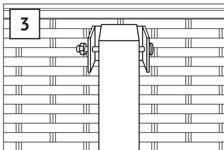
Befestigen Sie den Stützbügel mit den Schrauben und Hutmuttern (G) an den U-Profilen.
