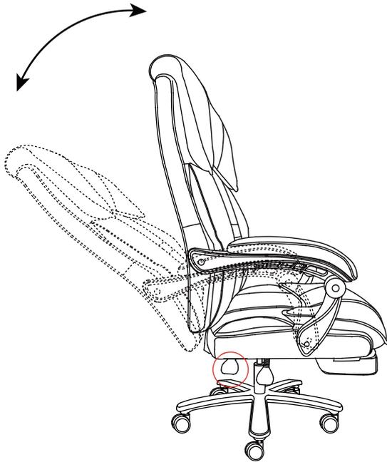
Ziehen Sie den Hebel **VOLLSTÄNDIG** und lehnen Sie sich langsam zurück, bis der gewünschte Winkel erreicht ist. Dann bringen Sie den Hebel langsam in seine Ausgangsposition zurück.
