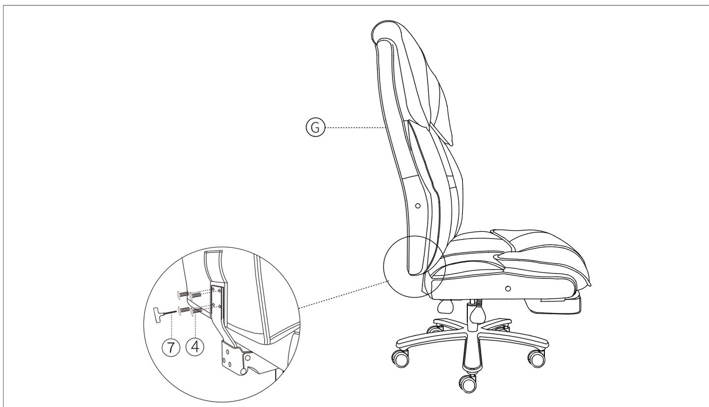
**SCHRITT 7:** Befestigen Sie die Armlehne mit M8\*45mm Schrauben auf beiden Seiten, mit dem T-Schraubenschlüssel.
