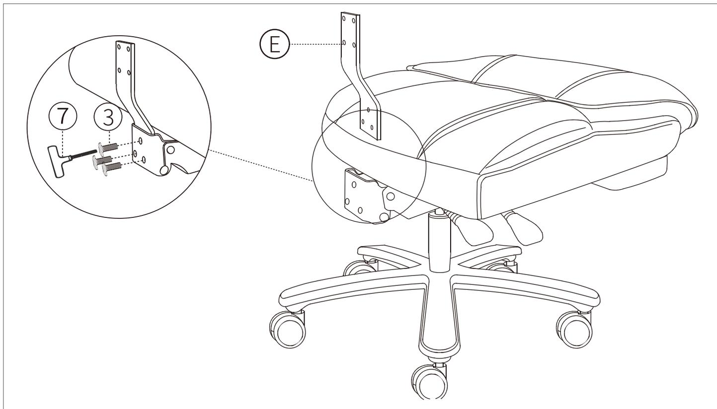
**SCHRITT 6:** Befestigen Sie die Stahlplatte am Rückenkissen mit vier M6x25mm Schrauben.
