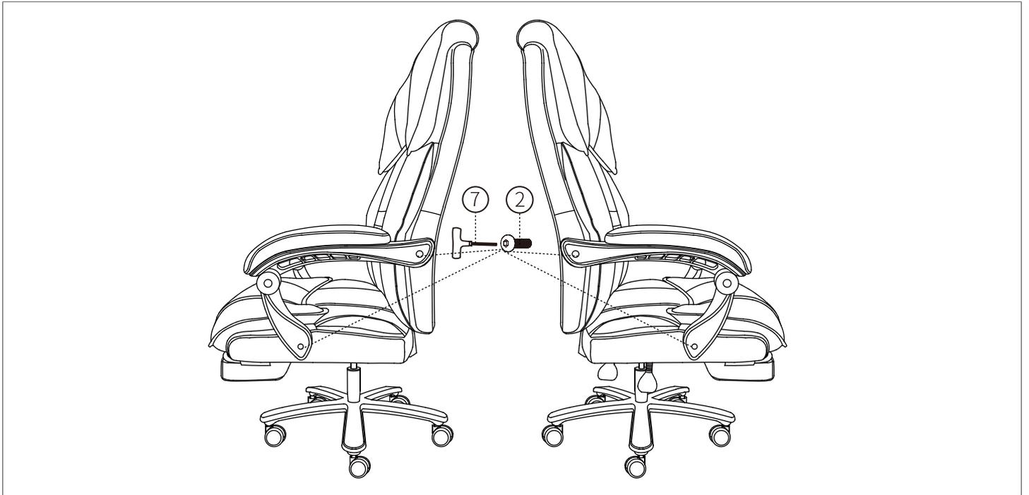
**SCHRITT 8:** Drücken Sie die Kunststoffkappen in die Einstelllöcher, um die Schrauben abzudecken.
