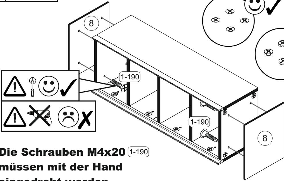
**Die Schrauben M4x20 (1-190) müssen mit der Hand eingedreht werden.**
