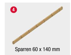
Länge = 2950 / 3950 mm Menge 3 m Breite = 4 St. Menge 4 m Breite = 5 St. Menge 5 m Breite = 6 St.
