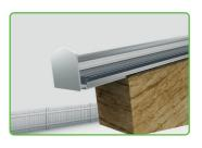
Legen Sie die vorbereiteten Profilunterteile nacheinander auf. Unterscheiden Sie dabei zwischen Rand- und den Mittelprofilen. Liegen alle Profile an der richtigen Position, schlagen Sie die Abschluss- und Haltewinkel an die Sparren an.
