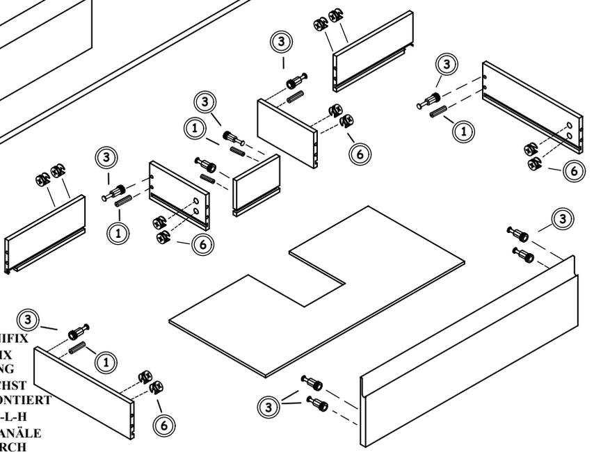
WÄHREND DER MONTAGE DER SCHUBLADE SIND DIE MINIFIX VERBINDERGEHÄUSE, KUNSTSTOFF DÜBEL UND MINIFIX VERBINDUNGSBOLZEN ENTSPRECHEND DER ANWEISUNG ANZUBRINGEN. HIERZU MÜSSEN DIE TEILE M-O-N ZUNÄCHST VERBUNDEN UND DURCH DAS FESTZIEHEN DER MINIFIXE MONTIERT WERDEN. ANSCHLIESSEND MÜSSEN DIE TEILE G-K-M-O-N-L-H MONTIERT WERDEN. SCHUBLADEN BODEN DANN DURCH KANÄLE EINSCHIEBEN UND SCHUBLADEN FRONT ANBRINGEN. DURCH FESTZIEHEN DER MINIFIXE ZU ENDE MONTIEREN.
