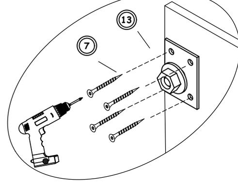
MONTIEREN SIE DAS AUFHÄNGUNGSELEMENT AN DEN SCHRANK.
