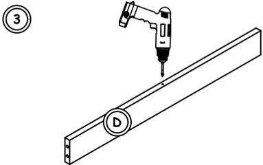
BOHREN SIE EIN LOCH AM UNTEREN BEREICH DES HINTEREN ELEMENTS UNTER VERWENDUNG EINER BOHRMASCHINE UND EINEM 3MM BOHRER.
