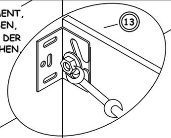
BOHREN SIE MIT EINEM SCHLAGBOHRER LÖCHER ENTSPRECHEND DER ANGEZEIGTEN ABSTÄNDE ZUR ANBRINGUNG DER AUFHÄNGUNGSELEMENTE. STECKEN SIE ANSCHLIEßEND DIE DÜBEL IN DIE LÖCHER. VERSCHRAUBEN SIE DIE AUFHÄNGUNGSELEMENTE IN DIE ANGEBRACHTEN DÜBEL.
