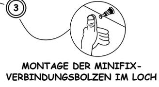
MONTAGE DER MINIFIX-VERBINDUNGSBOLZEN IM LOCH
