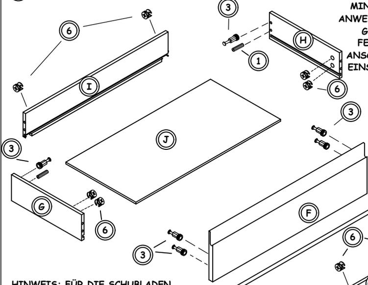
HINWEIS: FÜR DIE SCHUBLADEN MÜSSEN DIE MINIFIX VERBINDERGEHÄUSE (KLEIN) VERWENDET WERDEN.
