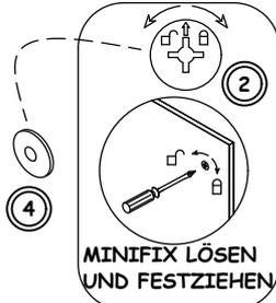
PLATZIEREN SIE DIE MINIFIX STECKER UND VERBINDUNGSGEHÄUSE UND SCHRAUBEN SIE DIESE FEST.
