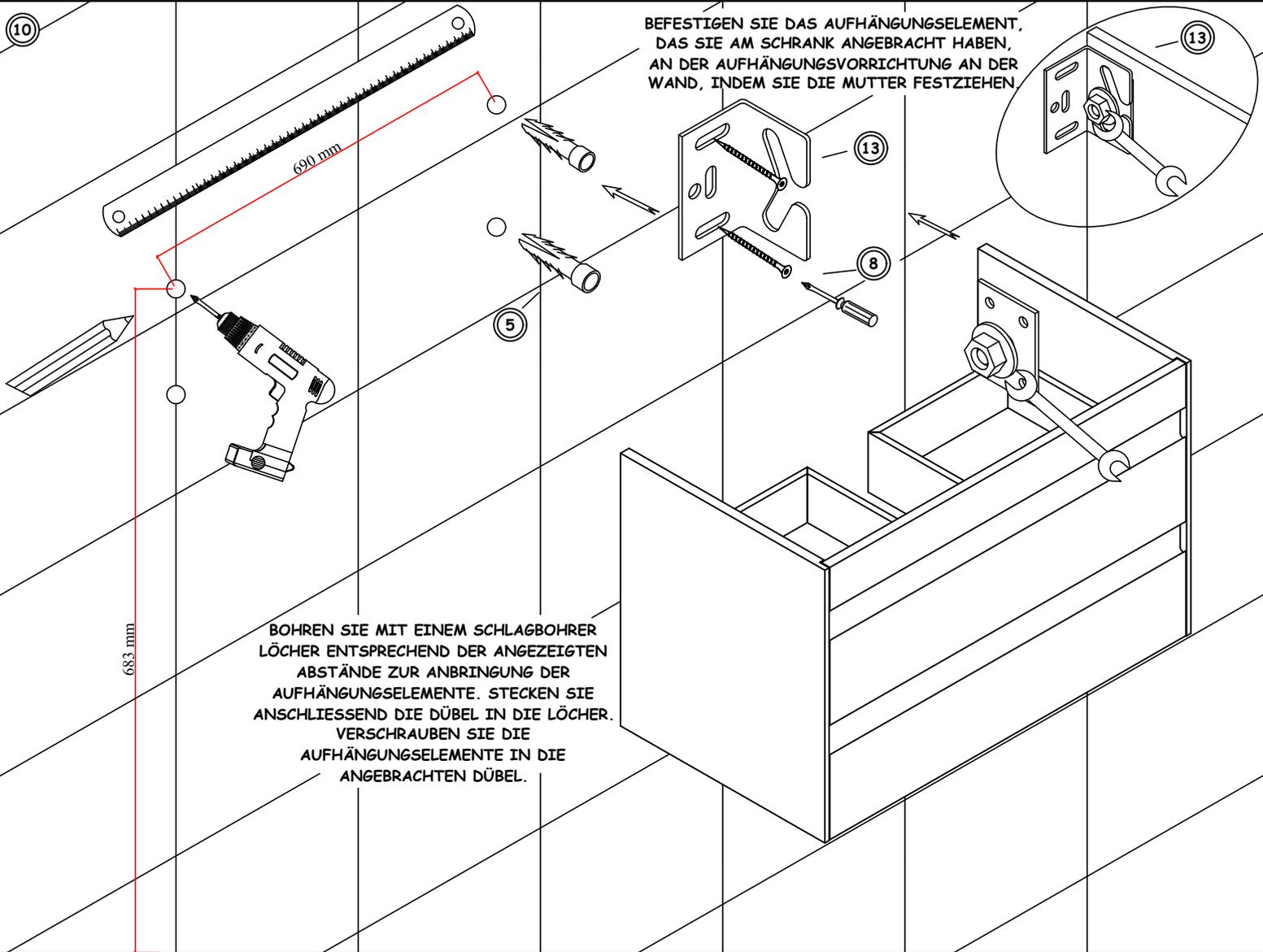
BEFESTIGEN SIE DAS AUFHÄNGUNGSELEMENT, DAS SIE AM SCHRANK ANGEBRACHT HABEN, AN DER AUFHÄNGUNGSVORRICHTUNG AN DER WAND, INDEM SIE DIE MUTTER FESTZIEHEN.
