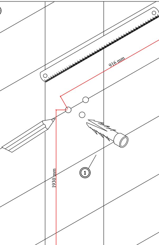
BOHREN SIE MIT EINEM SCHLAGBOHRER LÖCHER ENTSPRECHEND DER ANGEZEIGTEN ABSTÄNDE ZUR ANBRINGUNG DER AUFHÄNGUNGSELEMENTE. STECKEN SIE ANSCHLIESSEND DIE DÜBEL IN DIE LÖCHER.
