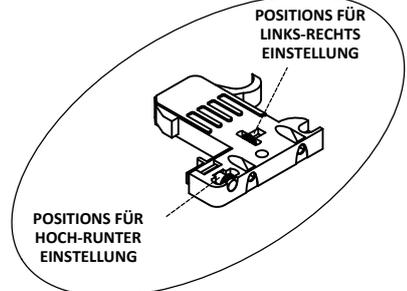
NACHDEM DIE SCHUBLADEN ANGEBRACHT SIND, KÖNNEN ÜBER DIE VERRIEGELUNGSELEMENTE LEICHTE EINSTELLUNGEN LINKS-RECHTS UND HOCH-RUNTER VORGENOMMEN WERDEN.
