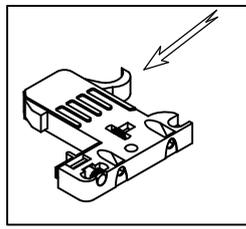
DURCH DAS GLEICHZEITIGE DRÜCKEN AUF DIE SCHULTERN DER VERRIEGELUNGSELEMENTE, KANN DIE SCHUBLADE AUS DEM SCHRANK ENTNOMMEN WERDEN.
