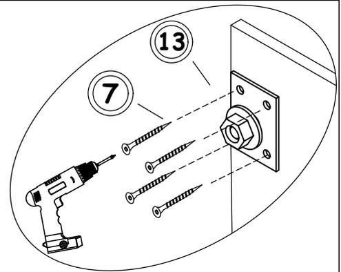
MONTIEREN SIE DAS AUFHÄNGUNGSELEMENT AN DEN SCHRANK.
