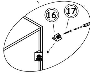
PLATZIEREN SIE DIE HINTEREN PINS IN DIE LÜCKE ZWISCHEN RÜCKWAND UND BRETTER UND SCHRAUBEN SIE DIESE FEST
