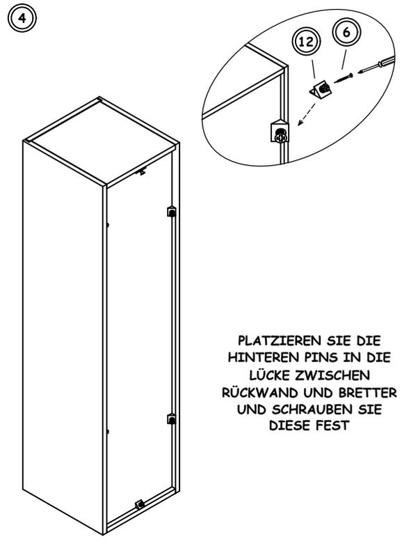
PLATZIEREN SIE DIE HINTEREN PINS IN DIE LÜCKE ZWISCHEN RÜCKWAND UND BRETTEN UND SCHRAUBEN SIE DIESE FEST
