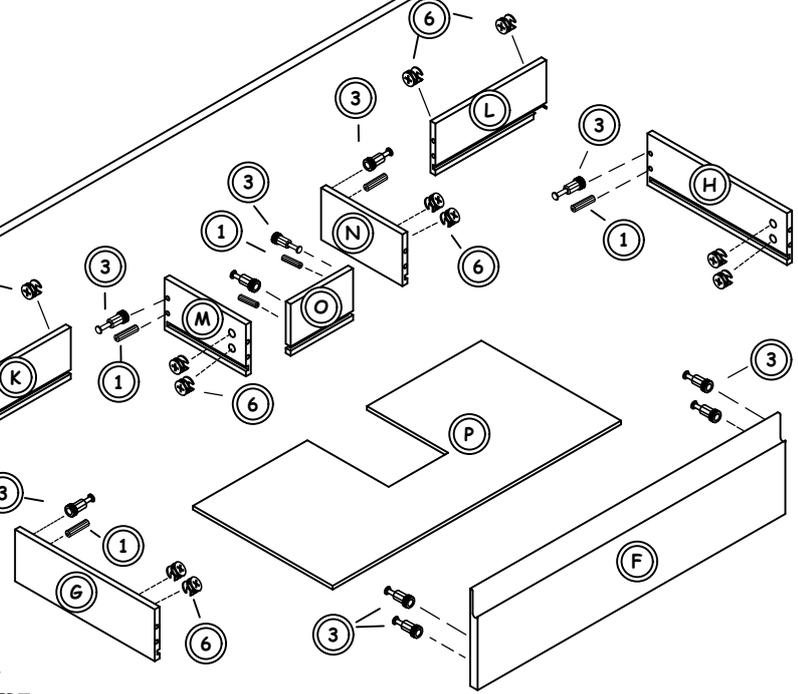
WÄHREND DER MONTAGE DER SCHUBLADE SIND DIE MINIFIX VERBINDERGEHÄUSE, KUNSTSTOFF DÜBEL UND MINIFIX VERBINDUNGSBOLZEN ENTSPRECHEND DER ANWEISUNG ANZUBRINGEN. HIERZU MÜSSEN DIE TEILE M-O-N ZUNÄCHST VERBUNDEN UND DURCH DAS FESTZIEHEN DER MINIFIXE MONTIERT WERDEN. ANSCHLIESSEND MÜSSEN DIE TEILE G-K-M-O-N-L-H MONTIERT WERDEN. SCHUBLADEN BODEN DANN DURCH KANÄLE EINSCHIEBEN UND SCHUBLADEN FRONT ANBRINGEN. DURCH FESTZIEHEN DER MINIFIXE ZU ENDE MONTIEREN.
