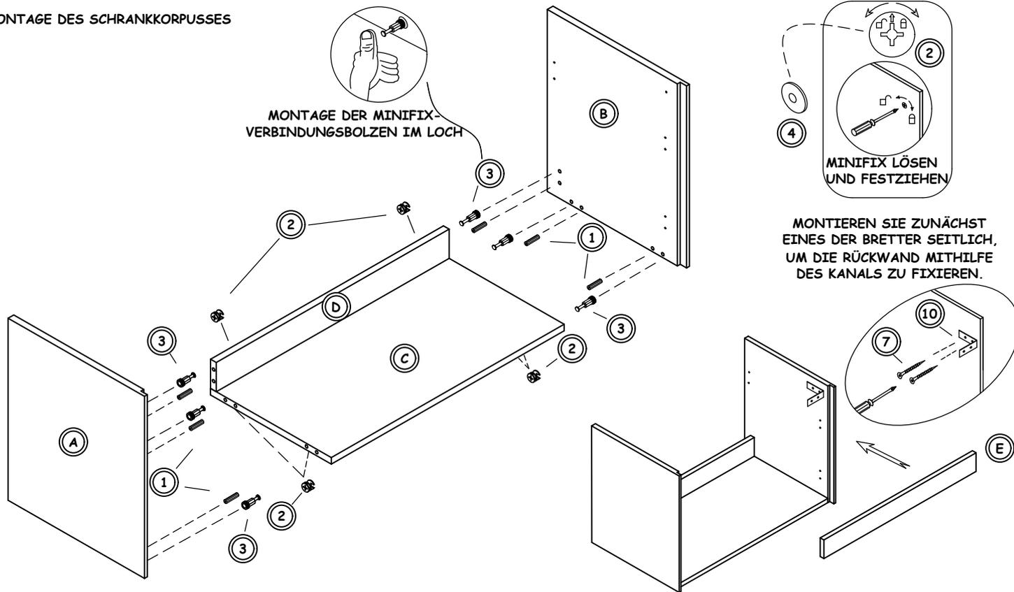
MONTAGE DER MINIFIX-VERBINDUNGSBOLZEN IM LOCH
