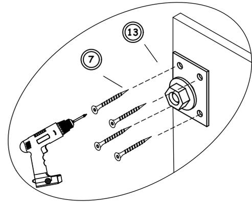
MONTIEREN SIE DAS AUFHÄNGUNGSELEMENT AN DEN SCHRANK.
