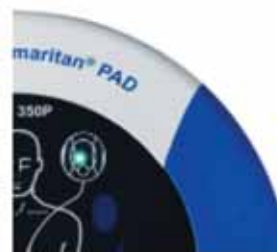
Abbildung 11. LED blinkt grün; keine Aktion erforderlich.
