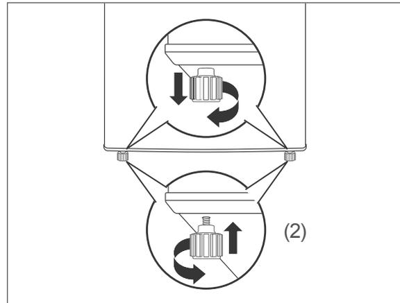
4. Gleichen Sie Unebenheiten des Untergrunds mithilfe der beiden vorderen Schraubfüße aus.
