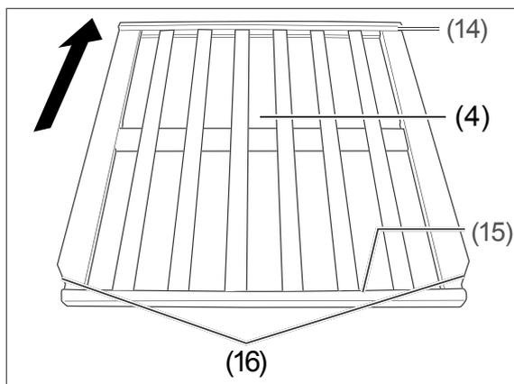
1. Drehen Sie das Flaschenbord (4) so, dass die vordere Leiste (15) und die hintere Leiste (14) nach oben sowie die Abschrägungen (16) nach vorne zeigen.
