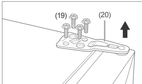
4. Sorgen Sie dafür, dass die Glastür (1) nicht wegrutschen kann, und lösen Sie die Schrauben (19) am oberen Scharnier (20). Verwenden Sie dazu einen Kreuzschlitz-Schraubendreher.
