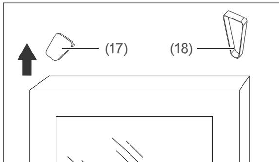
3. Drücken Sie die Blindplatte (17) und die Scharnierabdeckung (18) vorsichtig mit einem Schlitz-Schraubendreher nach oben, und heben Sie sie ab. Bewahren Sie die Blindplatte und die Scharnierabdeckung gut auf.
