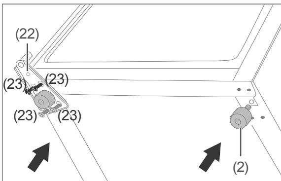
1. Schrauben Sie das untere Scharnier (22) auf der anderen Seite mithilfe der Schrauben (23) wieder fest.
