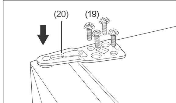
5. Befestigen Sie das obere Scharnier (20) mit den Schrauben (19).
