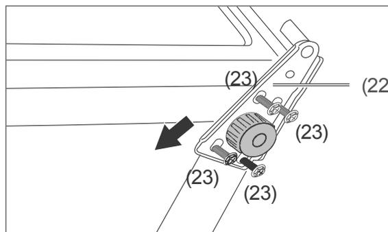
8. Lösen Sie die Schrauben (23), und ziehen Sie das untere Scharnier (22) vom Gerät ab.
